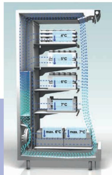
Das Temperature Equalizer System bietet auch neue Spielräume für die Auslagengestaltung: durch die optimierte Kaltluftzufuhr konnte die unterste mögliche Auslagenposition um 90 mm gesenkt werden.
